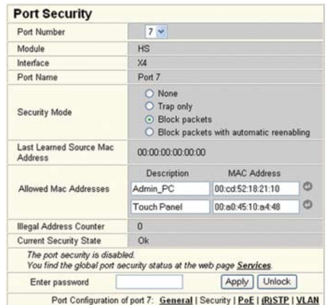
Figura 6: Configuração simples de acesso por endereço MAC, incluindo descrições para informar o sistema o ponto exato de tentativa de violação
